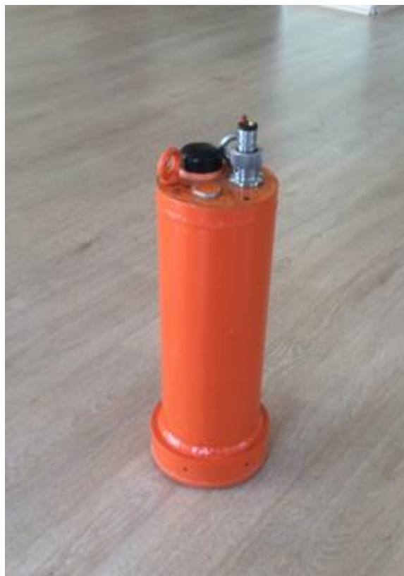
Рис. 2. Автономный геоакустический измерительный модуль на базе электронно-молекулярного преобразователя
