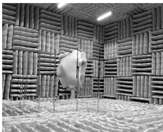
Рис. 2. Фотография и схема эксперимента по измерению шума струи с разными сопловыми насадками
